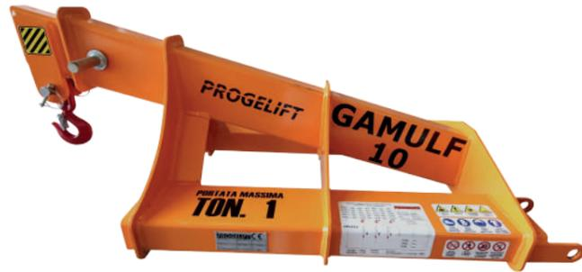
Es un equipo para carretilla elevadora que consta de una estructura fija con un brazo extensible, que puede tener una o más posiciones de ajuste. La extensión se puede ajustar insertando un pasador en los asientos apropiados. Al final del brazo hay un gancho giratorio fijado por un pasador.
